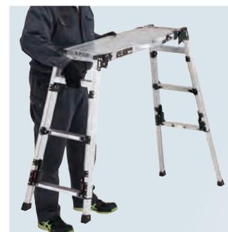
踏ざん内の伸縮操作バーの真ん中を引き上げれば2脚、端を引き上げれば1脚伸縮することができます。
