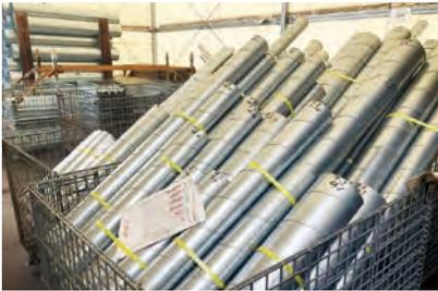
施工図からスパイラルダクトをプレハブ化。現場加工を削減します。
